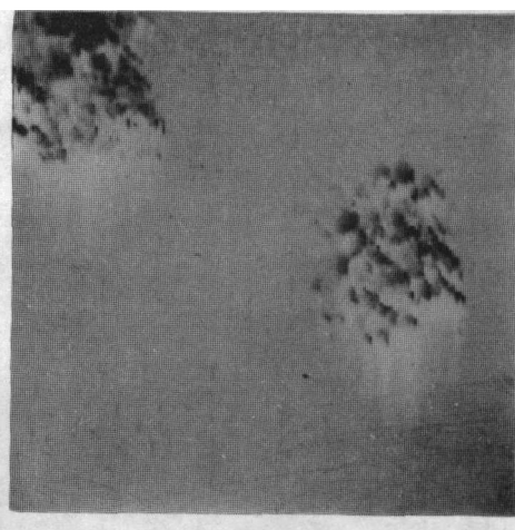
图6 脉冲参数大于6V时, 金尖在石墨表面产生由许多小突起形成的包扫描范围38nm×38nm, 脉冲参数8V, 10μs
