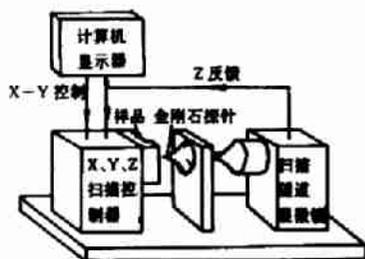
图3 AFM的工作原理图
