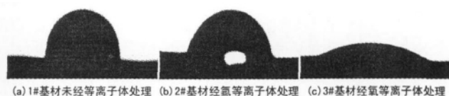
图 4 等离子体处理前后镀铜涤纶织物表面水滴形态
