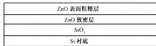
图 1 样品四层结构 SE 分析模型图
